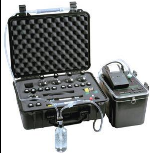
شكل(4) على اليسار صورة لجهاز RAD7 المستخدم لقياس غاز الرادون في هذه الدراسة وعلى اليمين مخطط RADH2O
